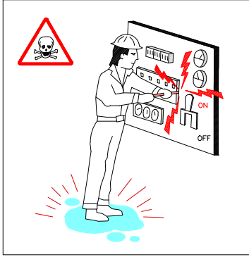
REPARACIÓ D'EQUIPS SOTA TENSIÓ
