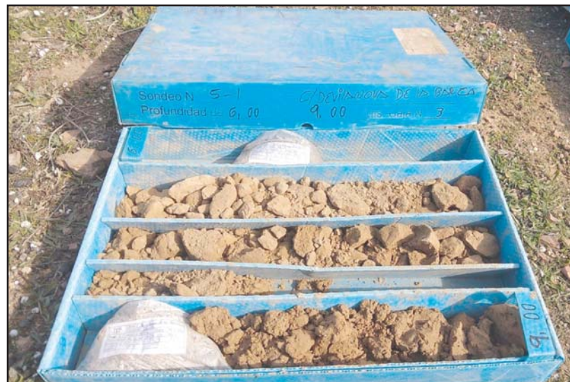
Fotografia 4. Material recuperat en el sondeig S-1 entre les cotes de -6.00 a -9.00 metres de profunditat.
