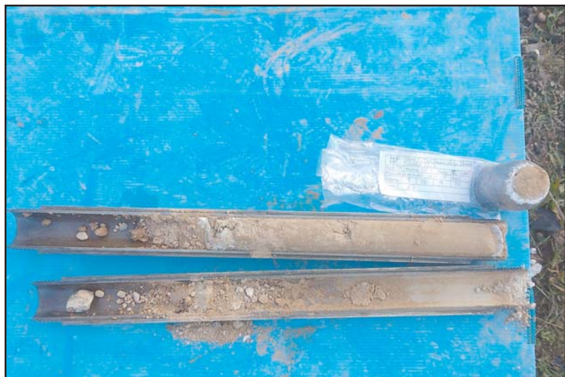
Fotografia 7. Detall dels materials recuperats en l'assaig SPT-2.
