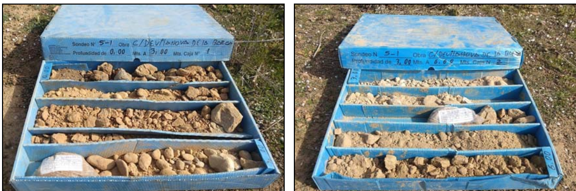
Fotografia 4 i Fotografia 5. Detall dels materials recuperats durant la realització del sondeig.
