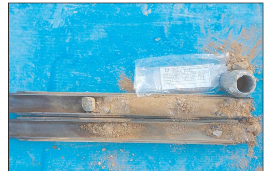
Fotografia 6. Detall dels materials recuperats en l'assaig SPT-1.
