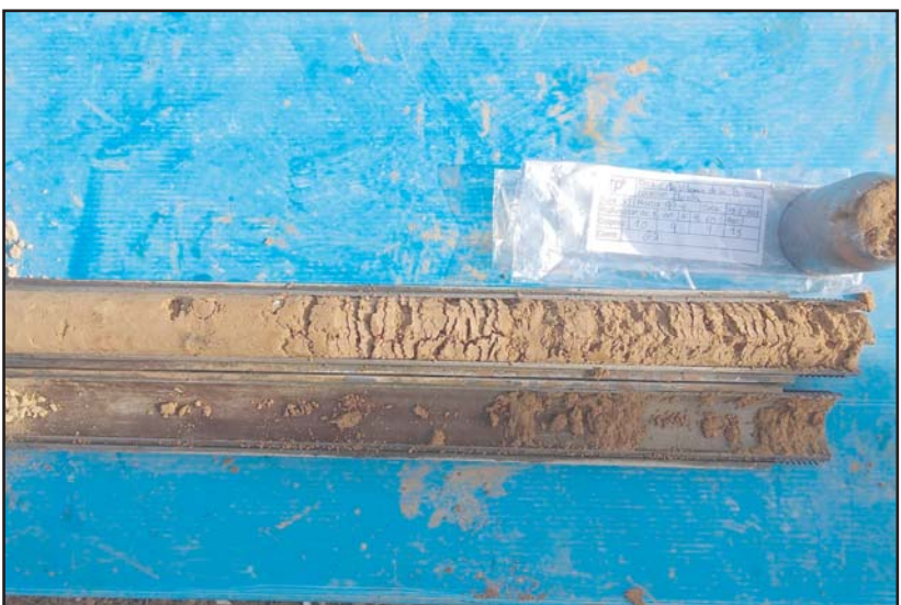
Fotografia 9. Detall dels materials recuperats en l'assaig SPT-4.
