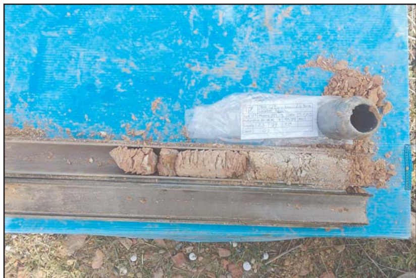
Fotografia 10. Detall dels materials recuperats en l'assaig SPT-5.
