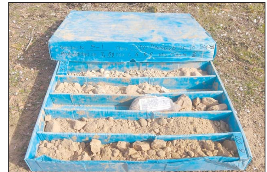
Fotografia 3. Material recuperat en el sondeig S-1 entre les cotes de -3.00 a -6.00 metres de profunditat.
