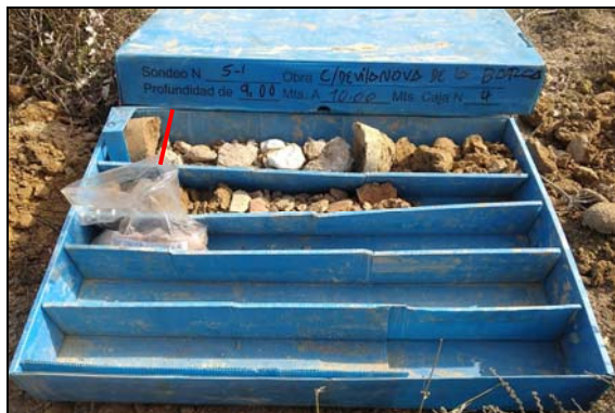
Fotografia 6 i Fotografia 7. Detall dels materials recuperats durant la realització del sondeig i de l'assaig SPT.
