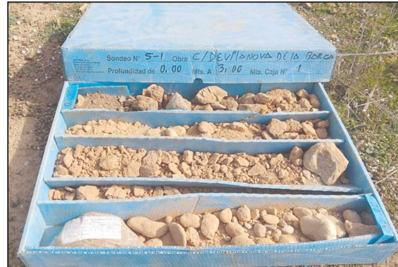
Fotografia 2. Material recuperat en el sondeig S-1 entre les cotes de 0.00 a -3.00 metres de profunditat.
