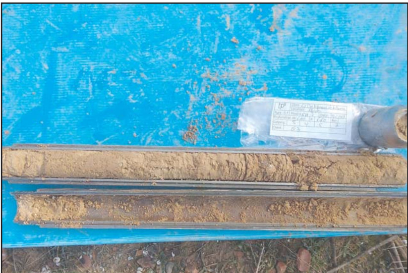
Fotografia 8. Detall dels materials recuperats en l'assaig SPT-3.
