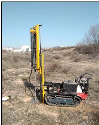
Fotografia 2. Vista de la màquina utilitzada en un dels assaigs de penetració dinàmica realitzats.
