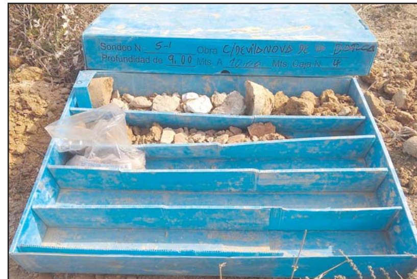
Fotografia 5. Material recuperat en el sondeig S-1 entre les cotes de -9.00 a -10.00 metres de profunditat.
