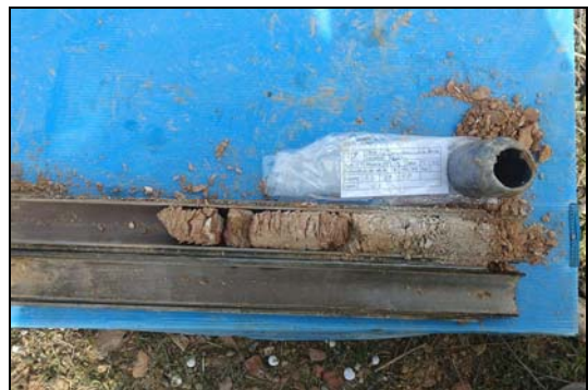
Fotografia 6 i Fotografia 7. Detall dels materials recuperats durant la realització del sondeig i de l'assaig SPT.
