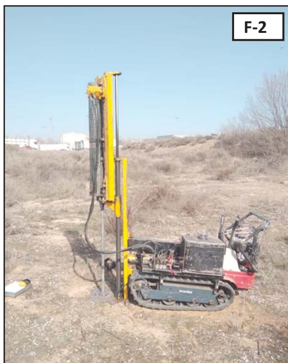
Fotografies 1 i 2: Vista general de la parcel·la i detall de l'emplaçament de la màquina realitzant l'assaig de penetració dinàmica DPSH P-1, respectivament.
