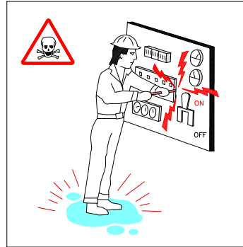
REPARACIÓN DE EQUIPOS BAJO TENSIÓN
