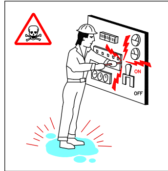
REPARACIÓN DE EQUIPOS BAJO TENSIÓN
