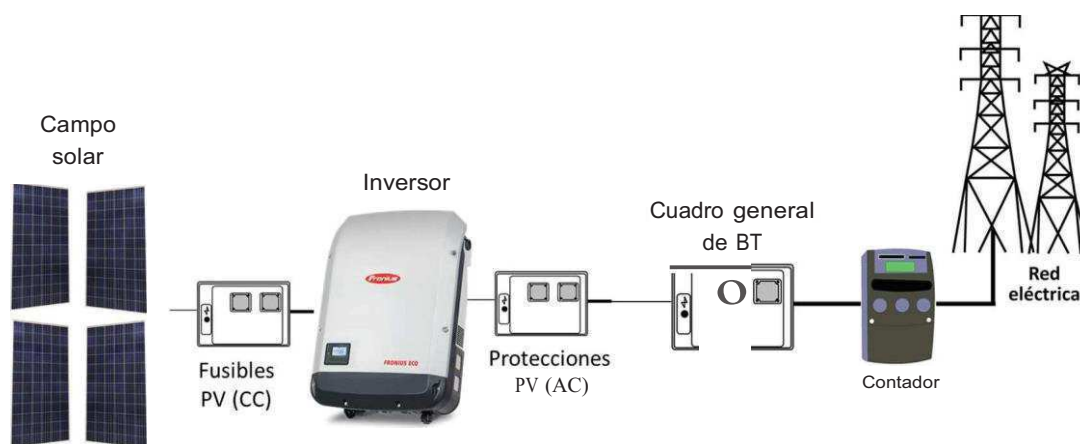
Figura 3. Esquema de funcionamiento de una instalación fotovoltaica proyectada.
