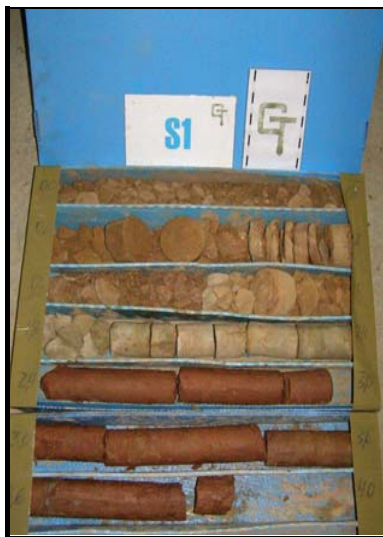
■ SONDEO ROTACIONAL – S1 : Emplazamiento y testimonios del sondeo S-1.
