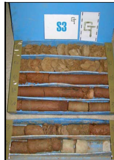
■ SONDEO ROTACIONAL – S3 : Emplazamiento y testimonios del sondeo S-3.
