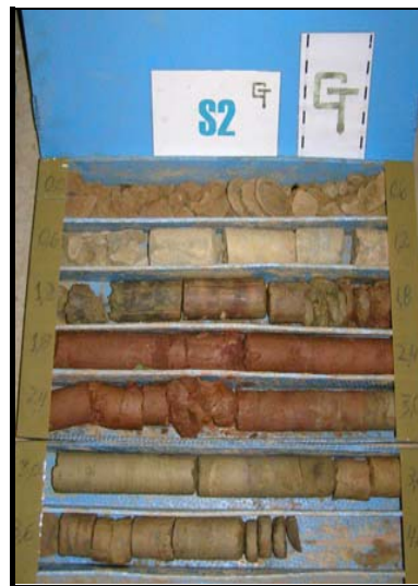
■ SONDEO ROTACIONAL – S2 : Emplazamiento y testimonios del sondeo S-2.
